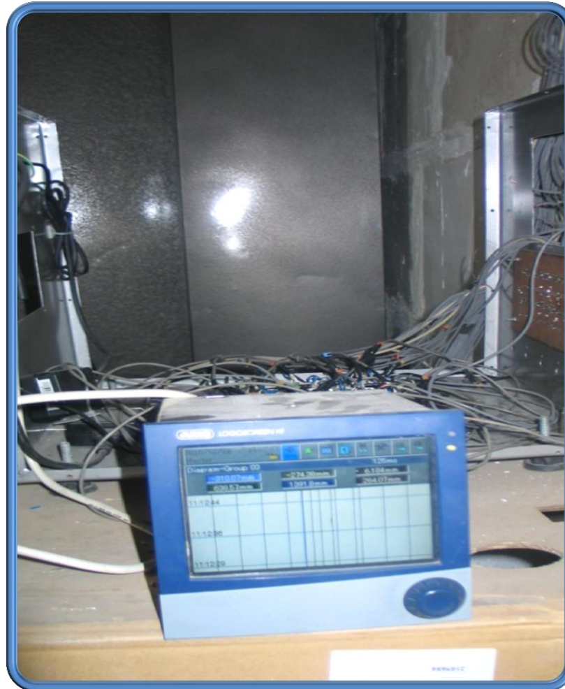
عکس شماره ۴۲ - اتاق مونیتورینگ کرنش سنجها
